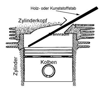
Dann dreht man die Kurbelwelle vorsichtig in Drehrichtung, bis der Kolben vor OT den Stab berührt. Diesen Blockierungspunkt zeichnet man an der Anlasserscheibe an, nimmt jetzt den Stab heraus, dreht die Kurbelwelle etwas über OT und schiebt den Stab beim gleichen Zylinder wieder hinein. Durch Drehen entgegengesetzt der Drehrichtung berührt der Kolben ebenfalls wieder den Stab. Auch dieser Blockierungspunkt wird an der Scheibe angezeichnet.
